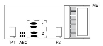
P1 .- Zero Adjust Potentiometer P2 .- Gain Adjust Potentiometer
